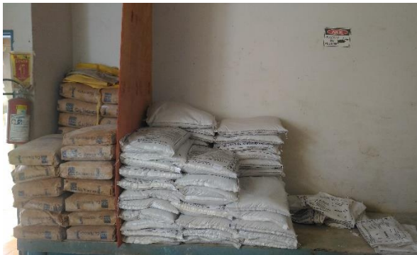
Figura 33 - Estocagem de Sulfato e Cal na ETA
