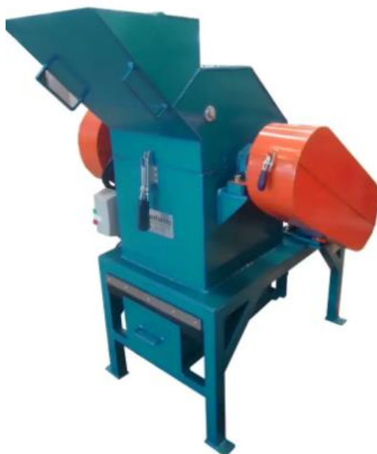
Figura 28 – Britador de RCC, para reaproveitamento do material.
